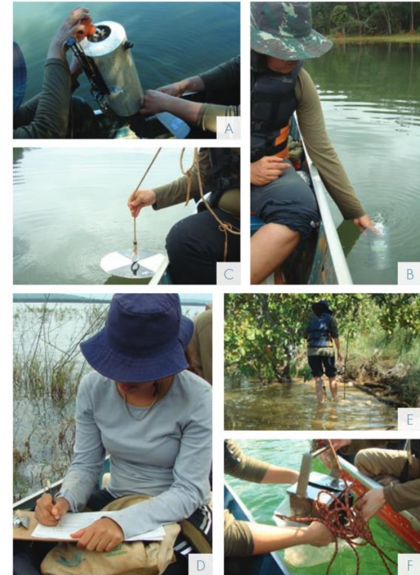
FIGURA 10 – Amostragem em reservatórios. Coleta de amostras de água (A; B; C), aplicação do protocolo de habitats físicos (D) e coleta de sedimento com os amostradores kick-net (E) e draga de Eckman-Birge (F).
